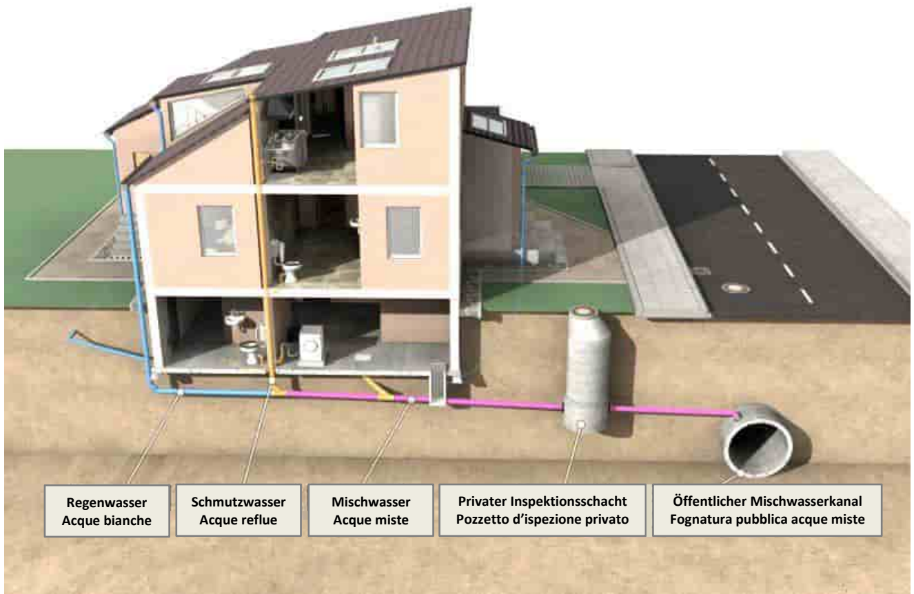
Mischwasseranschluss Ausnahmeregelung "Anschluss am Rohr"
